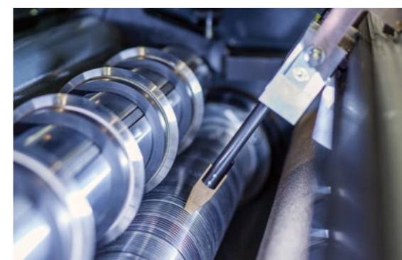
辅助定位 节省时间，精确对准底刀或刀槽套。
