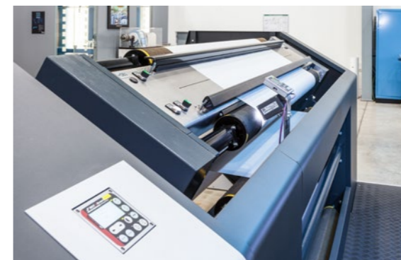
用于1,000 mm 放卷直径的接料台 高质量的接料台使操作更简便。整合的固定接料台。
