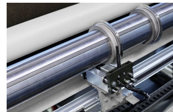
自动刀定位 可精确地设置分切位置，减少剪切刀具设置的时间。
