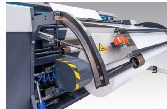
用于1,300 mm 放卷直径的接料台 可靠的伸缩式接料台，拥有安全和简便舒适的操作性。
